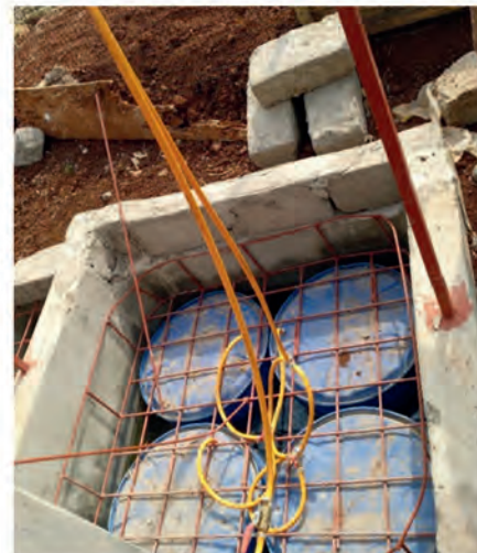
Kompression in Eigenbau mittels Wassertonnen und Steinen.
